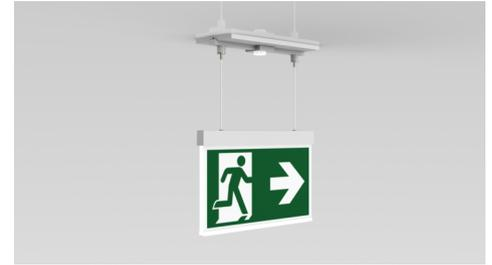
Moderne Zink-Druckguss Rettungszeichen-/Sicherheitsleuchte mit Seilabhängung zur Deckeneinbaumontage. Die Kennzeichnung der Rettungs- und Fluchtwege kann wahlweise ein- oder beidseitig erfolgen. Die Duo-Technik sorgt bei Stromausfall mit einer zusätzliche LED für die Ausleuchtung der Flucht- und Rettungswege.
