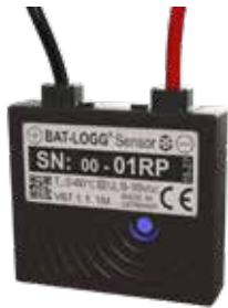
Moduł sensoryczny BAT-LOGG® (Wymiary: 38 x 34 x 10 mm)
