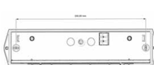
Distances de perçage KWI mur / plafond
