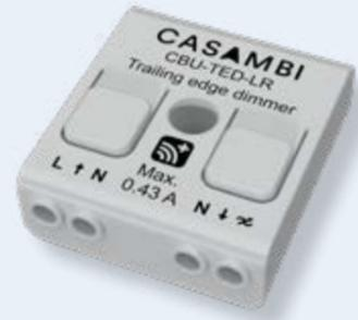
Das CBU-TED-LR Modul ist ein Bluetooth-gesteuerter Phasenabschnittsdimmer, der stufenloses Dimmen aller am Markt verfügbaren Leuchtmittel ermöglicht. Die Installation kann sowohl hinter einem herkömmlichen Lichtschalter als auch direkt in einer Leuchte oder einem Anschlusskasten erfolgen.
