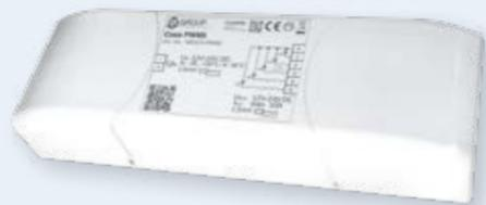
Die CASA PWM5 Einheit ermöglicht den direkten Zugriff auf vorkonfigurierte Funktionen der CASAMBI® Lichtsteuerung. Dazu zählen das Dimmen sowie das An- und Ausschalten von Leuchten, aber auch das Einstellen von Farben. Durch die Integration des fünften Kanals ist jetzt RGB CCT möglich. Angeschlossene Leuchten bleiben flickerfrei bis in niedrige Dimmstufen.
