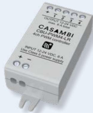
Das Modul dient zum einen zum Dimmen von Leuchten und zum anderen zum Einstellen von RGB und RGBW durch das in der App integrierte Farbauswahlfeld. Zudem können mithilfe von Animationen optisch ansprechende Farbverläufe realisiert werden. Das Modul kann beispielsweise 4 einzelne LED-Streifen oder zwei Tuneable white oder RGBW LED-Streifen steuern. Zur Versorgung des Moduls ist ein Konstant-Spannungsnetzteil von 12/24VDC erforderlich.
