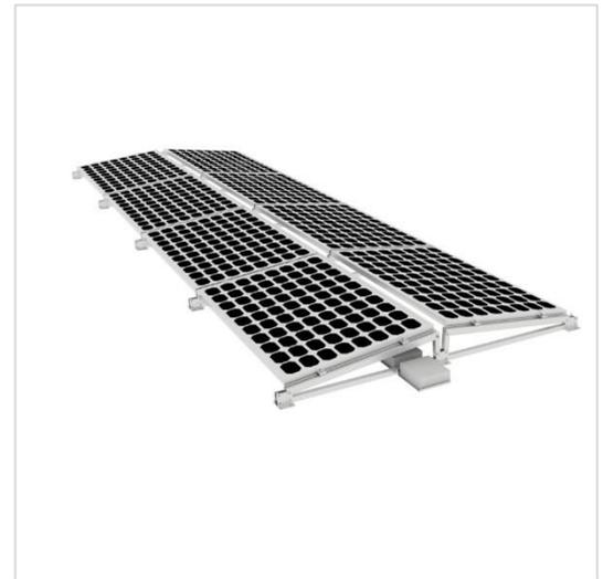
Für **8 Panels** zum direkten Aufstellen, mittels Ballastplatten, auf Flach/Foliendächern oder Bitumen Dächern. **10 Grad OST-West Ausrichtung**, Doppelten Dreieckshaltern, Befestigung-Clips, Endballastplatten, 3 Stück Mittelballastplatten und mit allen Hartgummi-Unterlegplatten. 16 Stück Ballaststeine 20 x 30 x 8 cm nicht enthalten.
