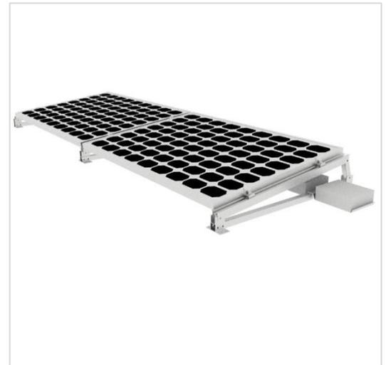
Für **4 Panels** zum direkten Aufstellen, mittels Ballastplatten, auf Flach/Foliendächern oder Bitumen Dächern. **10 Grad Winkel** mit Dreieckshaltern, Befestigungs-Clips, Endballastplatten, Mittelballastplatten und mit allen Hartgummi-Unterlegplatten. Hinweis: 16 Stück Ballaststeine 20 x 30 x 8 cm nicht enthalten.
