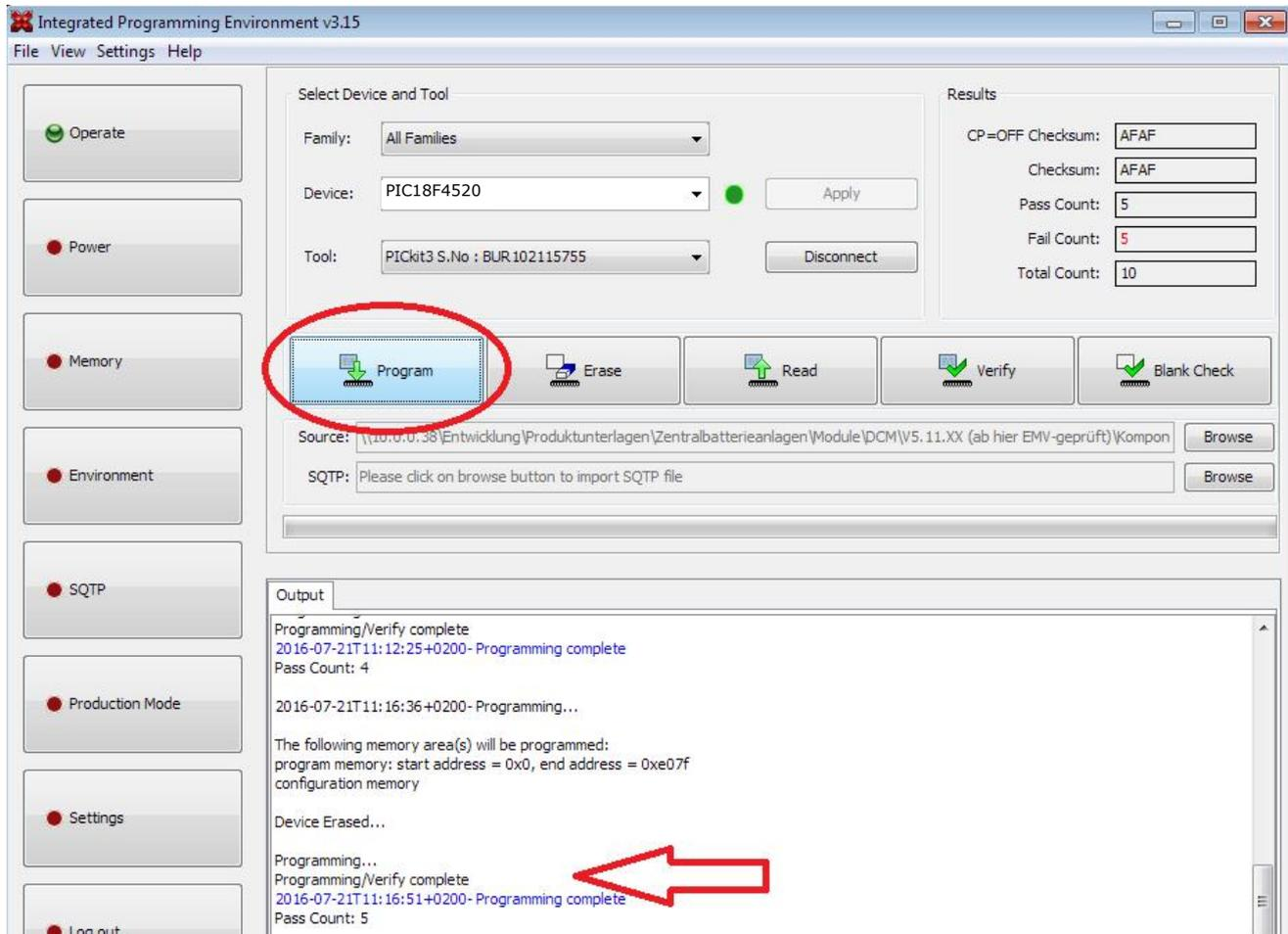
Nach der Programmierung erfolgt eine automatische Überprüfung der geschriebenen Daten. Der erfolgreiche Abschluss des Programmiervorganges wird durch die Zeile *Programming/Verify complete* bzw. *Programming complete* angezeigt.
