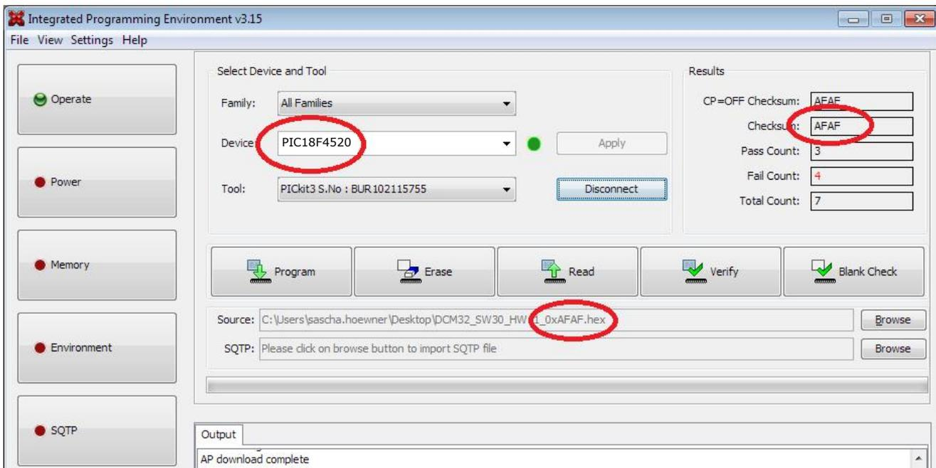
Wurde das PICKit3 zu diesem Zeitpunkt bereits mit dem PC verbunden, wird es in der Zeile *Tool* angezeigt. Andernfalls jetzt anstecken. Dann mittels Klicken auf *Connect* das PICKit3 auswählen.
