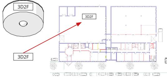
Die im Lieferumfang befindlichen zusätzlichen Aufkleber mit dieser Adresse können in der Tabelle im Handbuch und zur Kennzeichnung der Leuchtenposition in einem Installationsplan verwendet werden. Dies kann dann bei der Inbetriebnahme und Visualisierung eine nützliche Unterstützung sein.
