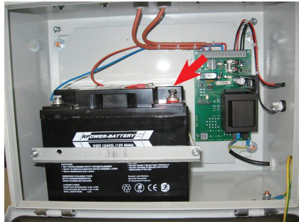
Das rote Kabel mit dem roten Batteriepol verbinden und das Gerät schließen. Die Halogenstrahler leuchten.
